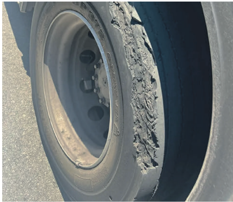
Estado de las ruedas que obligó a inmovilizar un autobús
